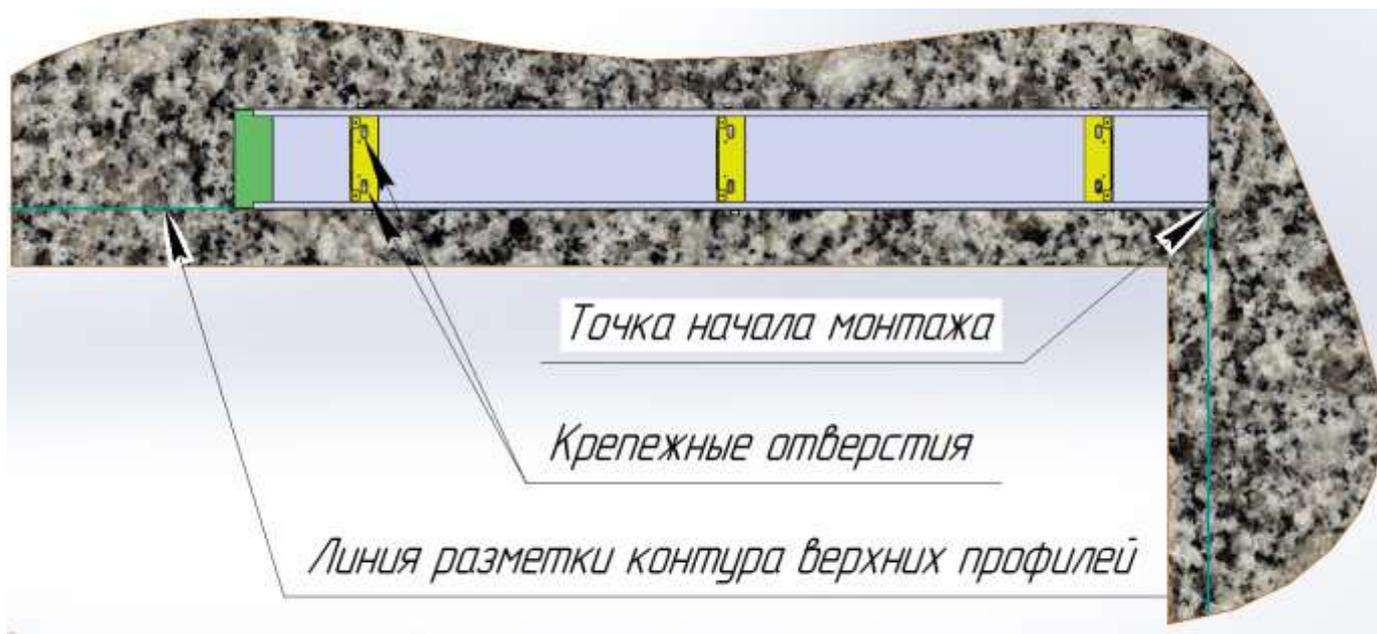
Рис. 7 – Монтаж секции верхнего профиля.
