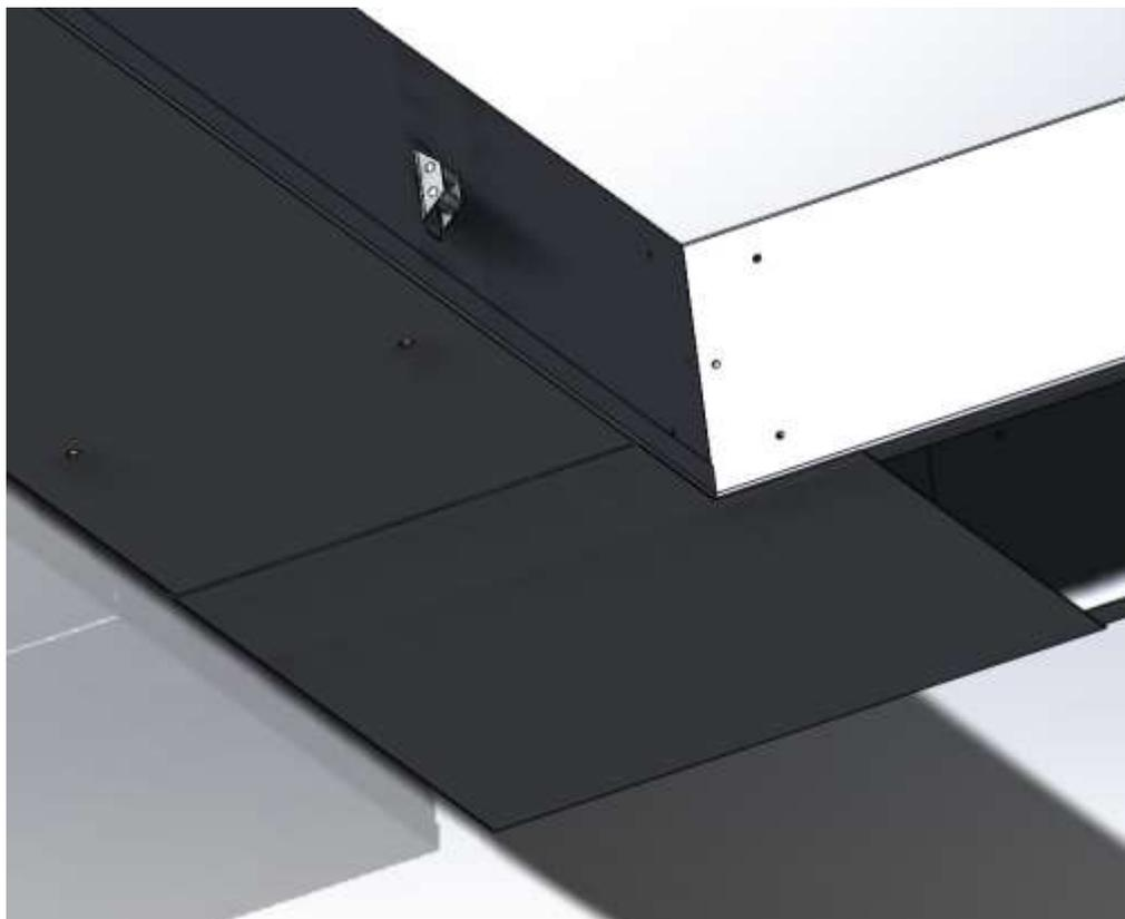
Рис. 9 Установка нижних панелей кожуха и угловых доборных элементов.
